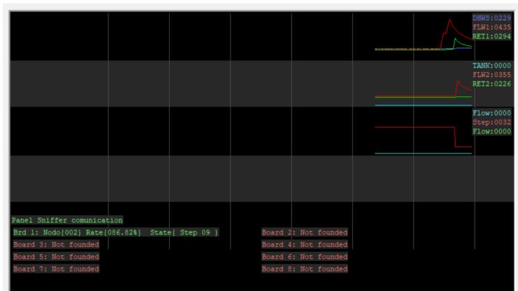
DHWS : 0209 (DHW supply sensor and 0229 is 22.9C ) FLW1 : 0435 (Primary Flow 43.5) RET1 : 0294 (Primary Return 29.4)
